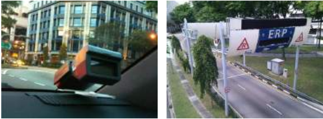
(図3-8-9) (左) 車載装置 (IU) と (右) ERP ガントリー
